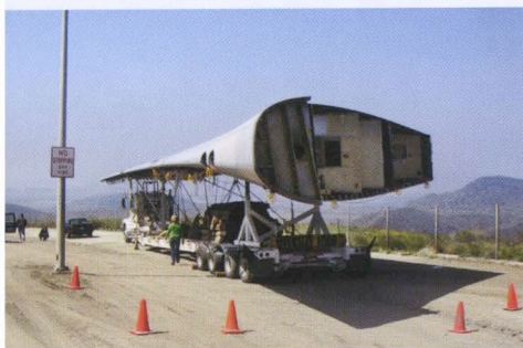
2. Each segment was transported by an oversized trailer to the closest airport to the site 分割された各部分は、敷地に近い飛行場まで大型トレーラーに乗せられて運ばれる
